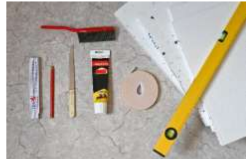
Abbildung 1: Du brauchst einen Gliedmaßstab, einen Stift und einen langen, geraden Gegenstand wie eine Wasserwaage. Einen Handfeger und einen Lappen. Ein Messer. Montagekleber oder doppelseitiges Klebeband. Dämmplatten in der richtigen Stärke. Und ein selbstklebendes Schaum- oder Schlauchband für die Abdichtung.
