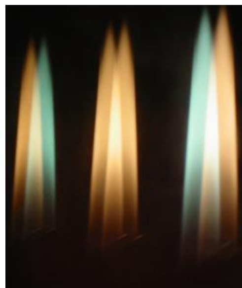
Abbildung 1: Die Flamme eines Feuerzeugs spiegelt sich in einer 3-fach-Verglasung. Die äußere Seite der raumseitigen Scheibe und die innere Seite der äußeren Scheibe sind beschichtet: Hier ist die Spiegelung verfärbt. Das Prinzip funktioniert bei einer 2-fach-Verglasung genauso. Ist eine der Flammen im Spiegelbild der 2-fach-Wärmeschutzverglasung verfärbt, weißt du, dies ist eine 2-fach-Wärmeschutzverglasung, die zusätzliche Folie lohnt sich dann nicht. Ist keine der Flammen verfärbt, lohnt sich die Folie.
