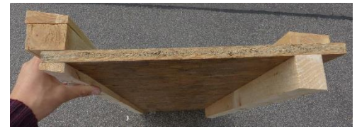
Abbildung 7: Fertigestellte Sägeschablone für unterschiedliche Keilgrößen oben bzw. unten
