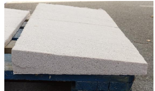
Abbildung 3: fertig geschnittener Dämmstoffkeil aus Mineralschaum
