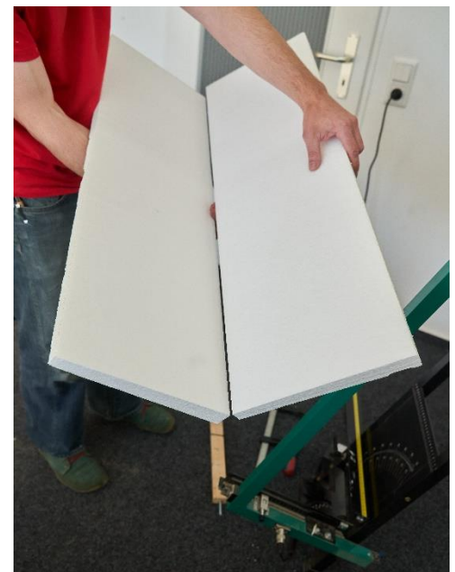
Abbildung 13: fertig geschnittene EPS-Keile
