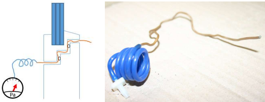
Abbildung 6: Kapillarröhrchen mit Schlauchverbindung zur Druckdifferenzmessung durch eine Fensterdichtung (z.B. für die Messung im obersten Geschoss).
