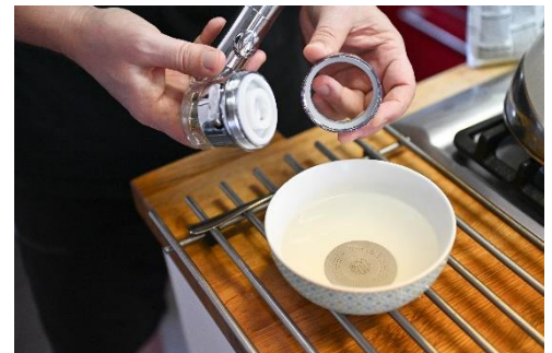
Abbildung 10: Entkalken der „Lochplatte“ eines auseinandergebauten Sparduschkopfes
