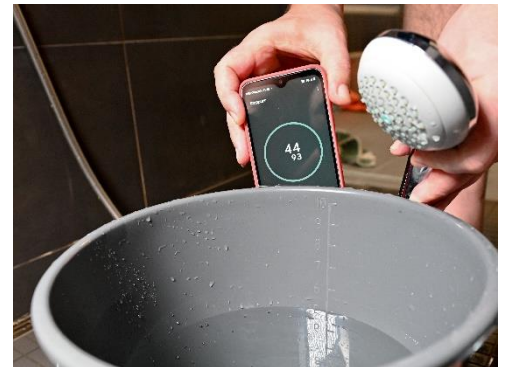
Abbildung 2: Bestimmung der Durchfluss-Wassermenge. Beispiel mit gutem Sparduschkopf: 60 / 40 \text{ Sek.} \times 3 \text{ Liter} = 4,5 \text{ Liter pro Minute.}
