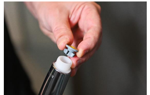
Abbildung 3: Durchflussreduktion mit einem „Restriktor“, den es auch zum Nachrüsten gibt.
