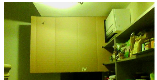
Abbildung 9: Eine Pappe im Luftstrom erlaubt es, die Temperatur der Luftströmungen zu visualisieren.
