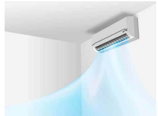
Abbildung 8: Splitgeräte saugen die Luft in der Regel unter der Decke an und blasen sie nach unten aus.
